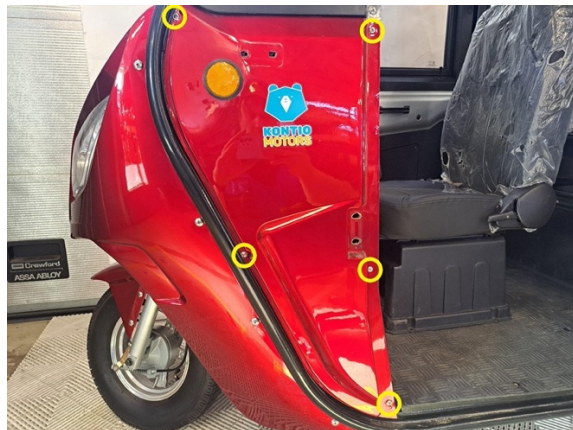
Irrota etusivupaneelin kiinnitysruuvit. (ristipäämeisseli ph2).
