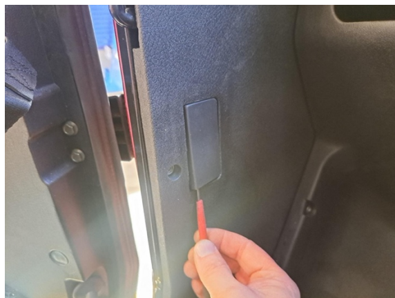
Raota oven alemman saranan kiinnitysmuttereiden suojakantta. (talttameisseli).
