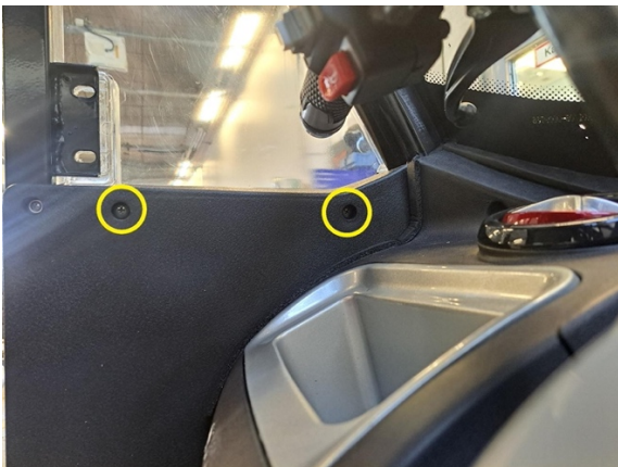
Irrota etummaisena sivuikkunan kiinnitysruuvit. (ristipäämeisseli ph2).
