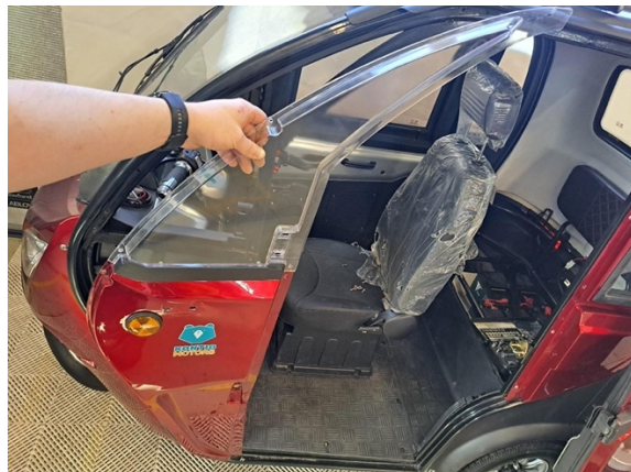
Ota etummainen sivuikkuna/ sivupaneeli pois.
